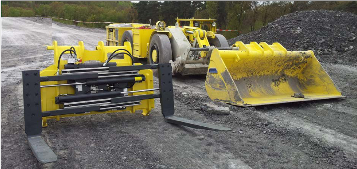
Abbildung 4: Beispiel für einen Fahrlader mit Wechselmodul (Fa. GHH Fahrzeuge)
