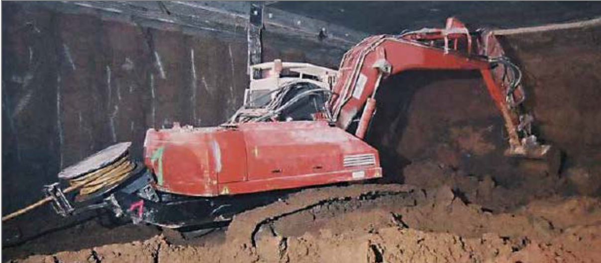
Abbildung 3: Beispiel für einen Abbruchroboter/Tunnelbagger (Fa. Terex)
